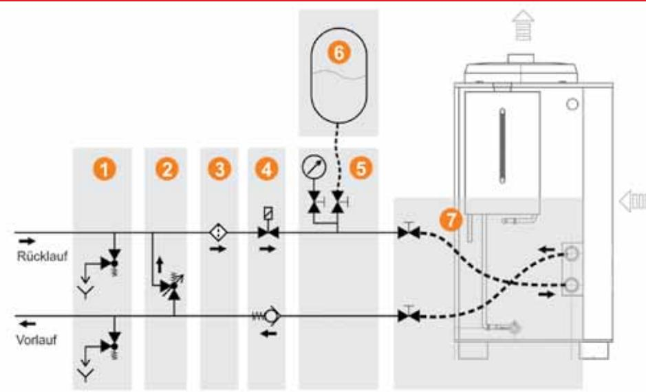
Anschluss-Schema (Prinzipdarstellung). Es gelten die Bedingungen in der Bedienungsanleitung des Herstellers.
